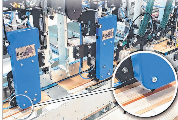
Enpro-Aggregate im Einsatz: Trennpapierstreifen (weiß) und Aufreißfäden (rot) werden auf Kartonzuschnitte appliziert.
